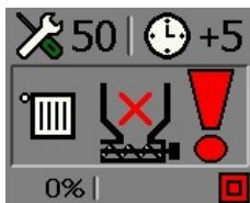
Alarm BRAK PALIWA
